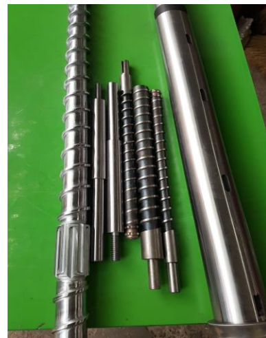
Phục hồi, chế tạo mới trục vít đùn máy nhựa, trục trơn các loại
