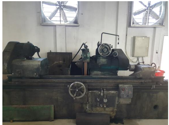
Máy mài tròn - 3A164 Chiều dài mài ngoài tối đa: 2000 mm Đường kính mài tối đa: 400 mm
