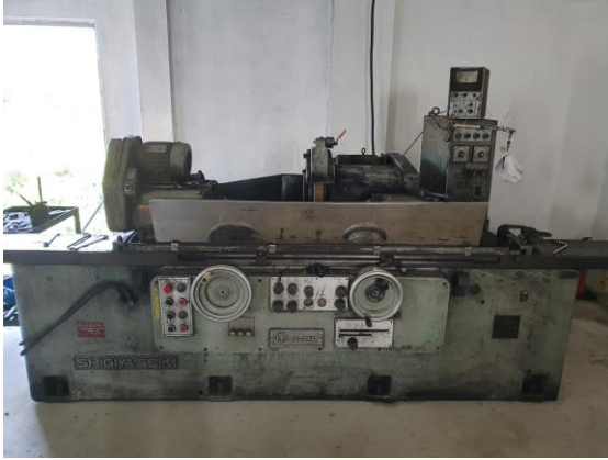
Máy mài tròn - SHIGIYA SEIKI Chiều dài mài ngoài tối đa: 1000 mm Đường kính mài tối đa: 300 mm
