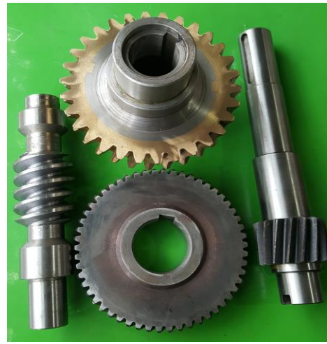
Chế tạo mới trục vít, bánh vít, trục răng, bánh răng hộp số
